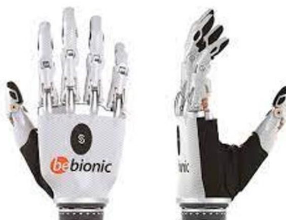
1.6-сурет – Көп функционалды биоэлектрлік протез
